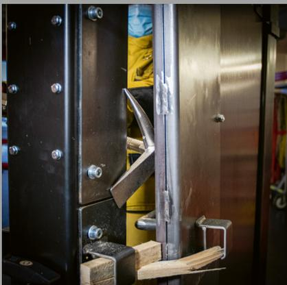
Querschneide und Runddorn ansetzen und Türe aufhebeln.
